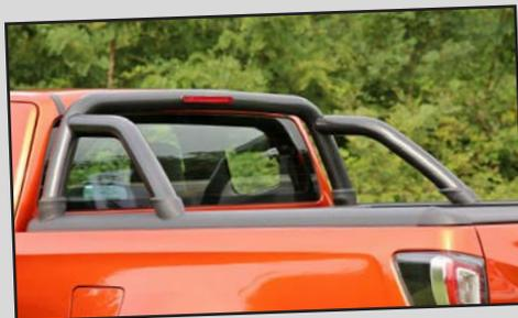
Autre accessoire dont était équipé notre modèle d'essai, un arceau de benne diamètre 76 mm prenait place derrière la cabine.
