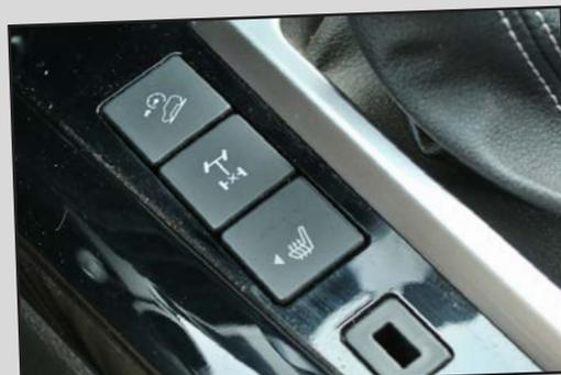
*Le bouton magique ! Sur le côté gauche du levier de BVA, vous trouvez l'interrupteur qui commande le verrouillage du pont arrière.*
