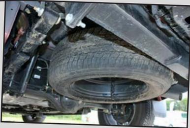
*À l'instar de tous les pick-up du marché, le New D-max embarque une roue de secours sous le plancher de sa benne.*
