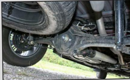
*Pas de révolution concernant la suspension arrière. Le D-max nouvelle génération reste fidèle à l'essieu rigide marié à des ressorts à lames.*
