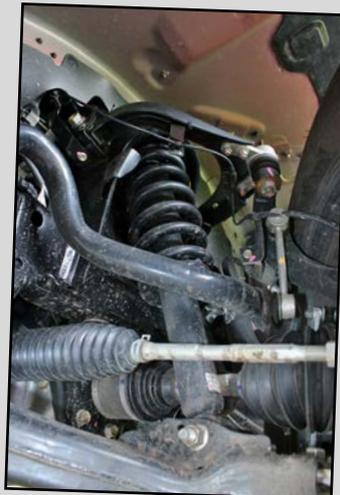
*Parmi les grosses divergences par rapport à la génération précédente, les ancrages des triangles supérieurs des roues indépendantes avant ont été décalés vers le haut de quelques centimètres. Résultat, le D-max 2021 est moins sujet au roulis.*
